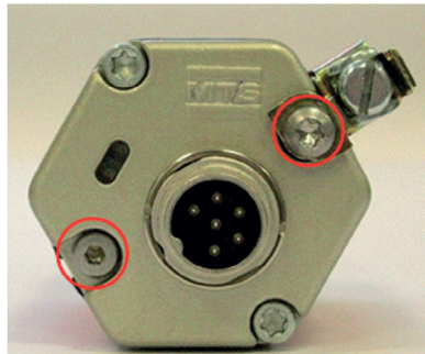
Abb. 2: Das Anzugsmoment zur Befestigung der Schrauben beträgt 1,3 Nm
