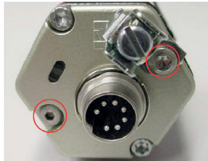
Abb. 2: Das Anzugsmoment zur Befestigung der Schrauben beträgt 1,3 Nm
