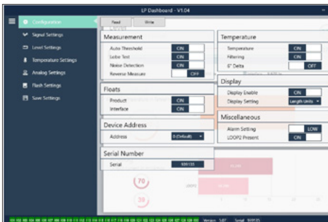
Fig. 5: Auf der Registerkarte „Configuration“ (Konfiguration) können Sie den Füllstandstransmitter für die spezifische Anwendung konfigurieren.
