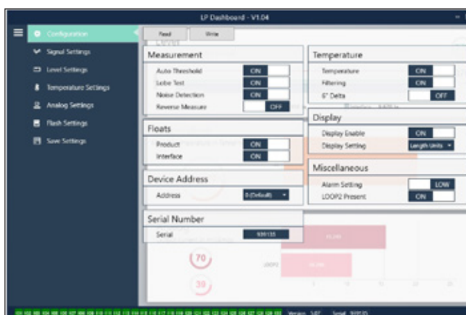
Fig. 5: La pestaña de configuración permite que el transmisor de nivel se configure para la aplicación específica.
