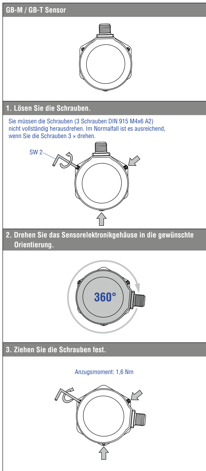
Abb. 18: Sensorelektronikgehäuse bzw. elektrischer Anschluss von GB-M / GB-T ausrichten
