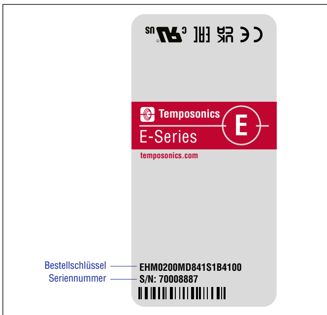
Abb. 1: Beispiel eines Typenschildes eines E-Serie EH Sensors mit SSI-Ausgang
