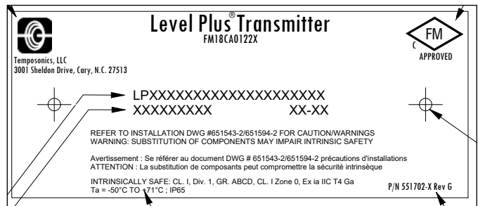
图33: 本质安全型FMC标签, Modbus和DDA, 单腔或双腔外壳
