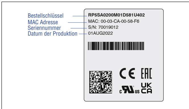
Abb. 1: Beispiel eines Typenschilds eines RP5 Sensors mit PROFINET-Ausgang
