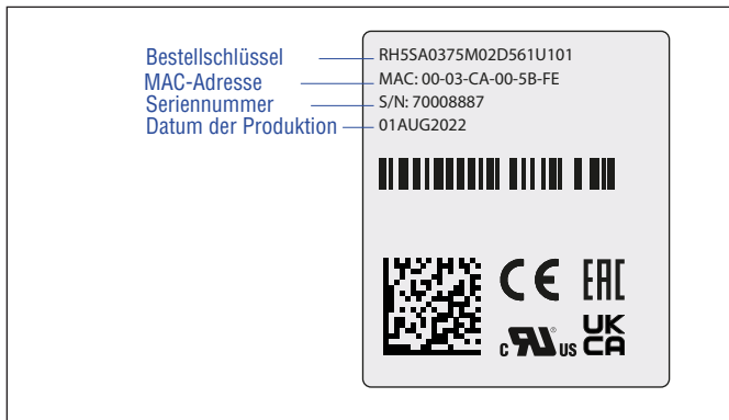
Abb. 1: Beispiel eines Typenschilds eines R-Serie V RH5 EtherCAT® Sensors
