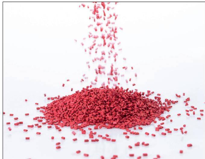
Abb. 2: Kunststoffgranulat zum Spritzgießen oder für die Extrusion
