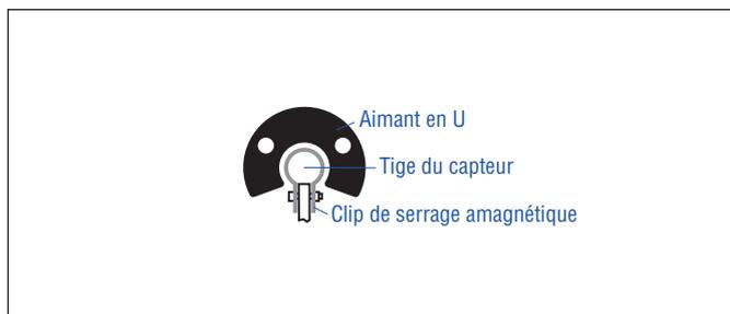
Fig. 12: Exemple de support de capteur (réf. 561 481)
