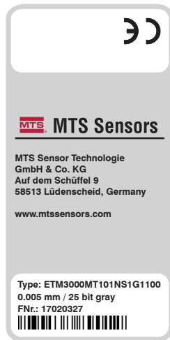
Abb. 2: Label für Sensor ohne Zulassung für den Einsatz in explosionsgefährdeten Bereichen
