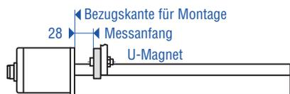
Abb. 6: Temposonics® Profilform mit U-Magnet OD33 <sup>7</sup>
