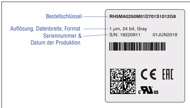
Abb. 1: Beispiel eines Typenschilds eines R-Serie V RH5 Sensors mit SSI-Ausgang
