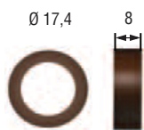
Ringmagnet Artikel Nr. 401 032 OD 17,4 mm ID 13,5 mm Höhe 8 mm Flächenpressung max. 10 N/mm 2 * in axialer Richtung
